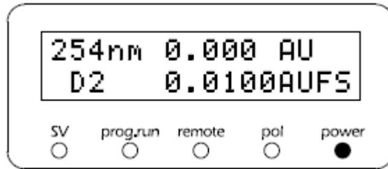
按一下 **func** 键，屏幕显示“LAMBDA 1”（设定检测波长），波长参数输入区闪烁，提示操作者输入波长值：
