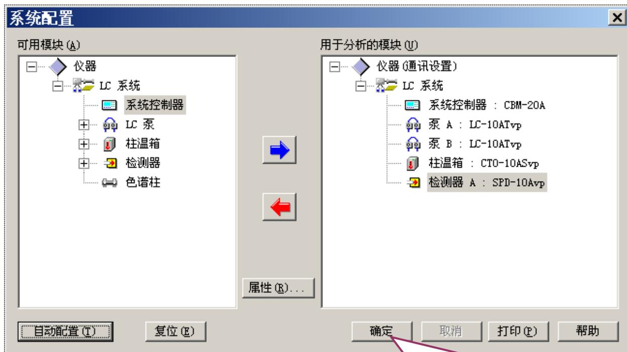
听见 LC 发出“哔”的声音，表示工作站与 LC 联机正常，仪器的配置也已自动完成，仪器各单元的名称在右侧框中列出，单击确定，仪器配置即告完成
