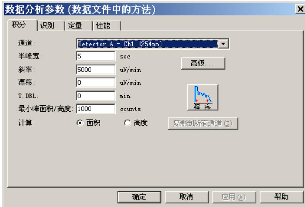
设置合适的半峰宽，斜率，最小峰面积等参数。点击确定后得到优化的色谱数据结果后，将参数另存为 test.lcm
