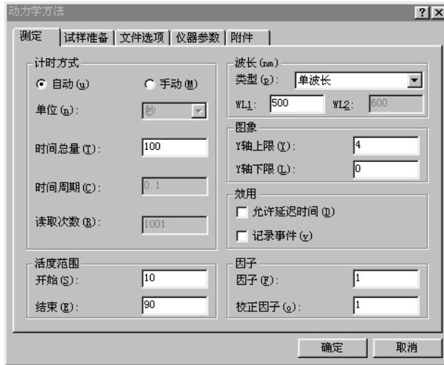
此处的计时方式选择的是“自动”，时间总量中需手动设置测定的时间。由于是自动计时方式，所以采样步长（图中为时间周期）和读数次数将根据时间总量自动设置。此外可设置波长以及活度计算的开始和结束时间。设置太短的活度范围会出现错误信息。相反，如果计时方式选择手动，则可输入时间周期和读取次数，而时间总量（测定时间）会根据输入的时间周期和读取次数自动计算得到。活度范围用于酶反应随时间的变化，如果单纯进行时间扫描的话，则可不考虑活度范围。
