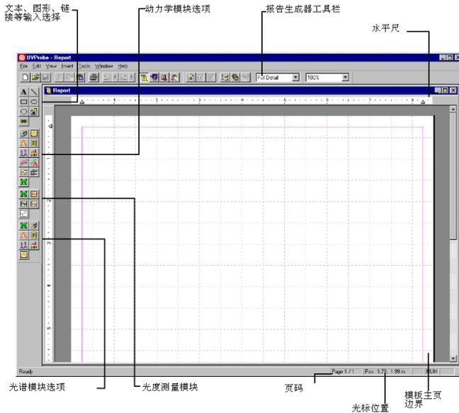
调用模板在 Progame files\Shimadzu\UVProbe \ Reports 安装目录下。然后在相应各目位置右键添加待打印谱图信息即可打印。
