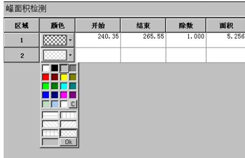
在此，即可选择颜色和网格等格式。面积计算可反复进行，没有限制。如果计算面积的区域想删除，可在欲删除的区域中点击鼠标右键，从出现的菜单中选择删除。
