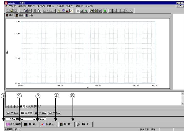
先在参比、样品池置入空白，点击上图②校正基线，然后点击③设置波长到 500nm，再点击①自动调零。（由于一般的分光光度计的能量在 500nm 左右最强，在此自动调零可得到最正确的基线。）通常上述操作在开机后进行一次就足够了。
