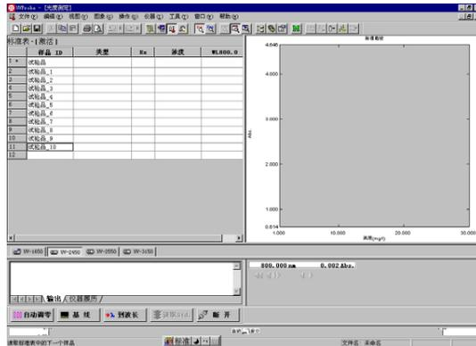
进行定量测定也需要基线校正和自动调零，方法如前面所述。
