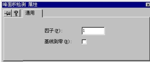
在基线到零的选择框中取消标记，图象和数据处理面板上的结果都将改变。
