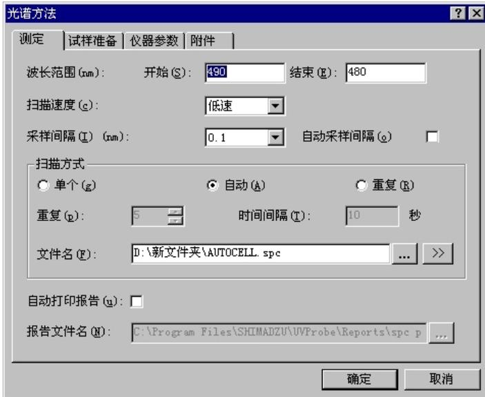
在此对话框中可选择波长测定的范围、扫描的速度、采样间隔等条件。
